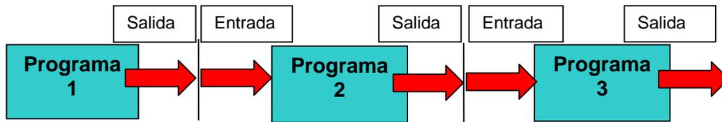
Figura 2.2 Tuberías en Linux
