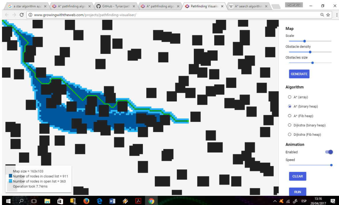
Figura 1. Ejemplo de ejecución de algoritmo A* para encontrar la ruta adecuada para evadir los obstáculos Tomado de: http://www.growingwiththeweb.com/projects/pathfinding-visualiser/
